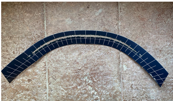
Exemple de banda de registre heliogràfic de l'heliògraf Campbell-Stokes instal·lat a l'Observatori Fabra de Barcelona (RACAB), i que s'utilitza per a la determinació de la insolació diària des del 1968. Foto: RACAB.
